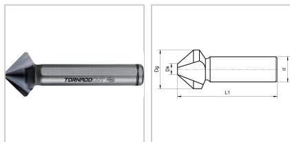
mit 3 Schneiden, axial und radial CBN-geschliffen, ideale Spanabfuhr durch revolutionäre Spanraumgeometrie, optimales Senkbild und extrem ruhiger Lauf durch optimierten variablen Hinterschliff, mit 3 Flächen am Schaft ab  $\varnothing$  8,3 mm, extrem hohe Verschleißfestigkeit und Warmhärte, Nano-Tec-Beschichtung für eine extra glatte Oberfläche und das Verhindern von Materialverschweißungen, arbeitet grat- und ratterfrei
